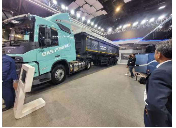
Exhibit 17: Volvo - LNG trailer FM 420 4x2T in 48 ton
